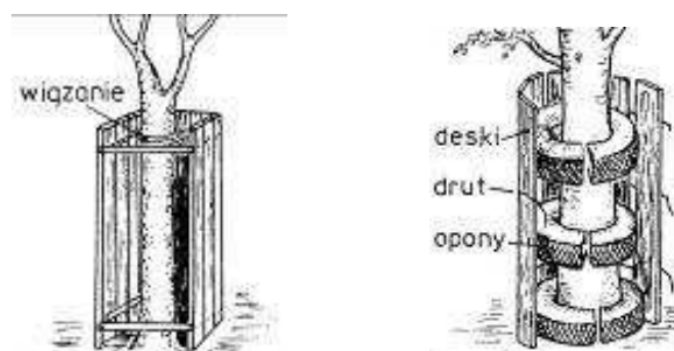
Rys. 3. Zabezpieczenie pni przed uszkodzeniami mechanicznymi i zasypaniem (zamiast opon użyć rur drenarskich lub mat słomianych).
