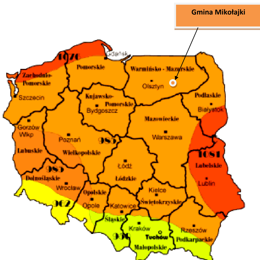
Rys. 1. Rejonizacja średniorocznych sum promieniowania słonecznego całkowitego padającego na jednostkę powierzchni poziomej w kWh/m 2 /rok
